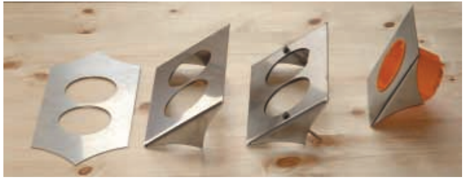
Edelstahlschablonen in den Fertigungsstufen: Zunächst wird die Form aus einem Blech gefräst, dann gekantet und mit Bohrungen für die Befestigung versehen.
